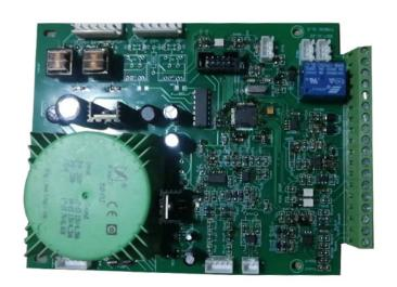
适应多于六个晶闸管元件的各种大型可控整流设备。具有完善故障、报警检测和保护功能。实时检测
