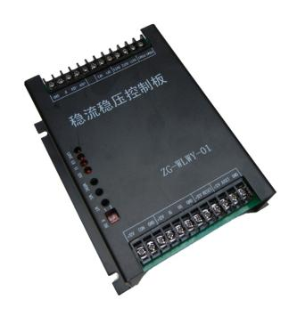
单相风机水泵调速节能控制\*电压、电流、功率、灯光等无级平滑调节2技术规格3可控硅触发板电压参数1、输入参数输入电压[]220/380VAC[]特殊电压要求可以定制);2、输出参数输入控制信号[]①4~20mA②0~10mA③0~5V④1~5V⑤0~10v⑥手动电位器控制备注:特殊信号需定制;输出电压[]0~220VAC连续无级平滑可调(调节无死区[][]0~380VAC连续无级平滑可调(调节无死区);可控硅额定电流[]20000A以下(特殊要求可以定制)。4可控硅触发板主要应用范围盐浴炉、工频感应炉、淬火炉温控;热处理炉温控;玻璃生产过程温控;金刚石压机加热;大功率充磁/退磁设备;半导体工业舟蒸发源;航空电源调压;真空磁控溅射电源;纺织机械;水晶石生产;粉末冶金机械;隧道电窑集散温控系统;彩色显像管生产设备;冶金机械设备;交直流电机拖动;石油化工机械;电压、电流、功率、灯光等无级平滑调节,恒压恒流恒功率控制等领域。正高电气我们完善的售后服务,让客户买的放心,用的安心。海南触发板组件
